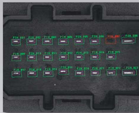
Erkennen von fehlenden Pins
